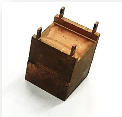
Slika 33: Elektroda 1 za oblikovni trn Vir: Rader, 2019
