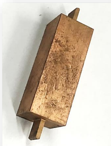
Slika 34: Elektroda 2 za oblikovni trn Vir: Rader, 2019
