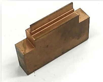
Slika 34: Elektroda 2 za oblikovni trn Vir: Rader, 2019
