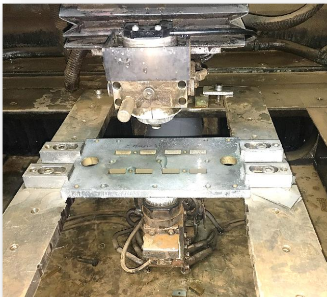
Slika 40: Izrez lukenj na žični eroziji Vir: Rader, 2019
