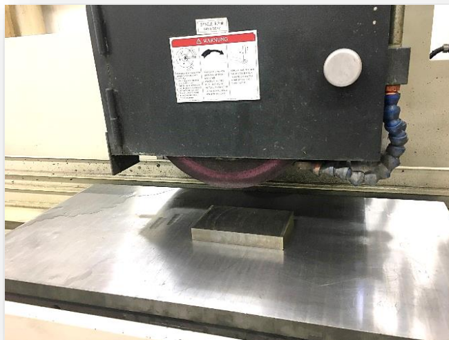
Slika 39: Brušenje na ploskovno brusilnem stroju Vir: Rader, 2019
