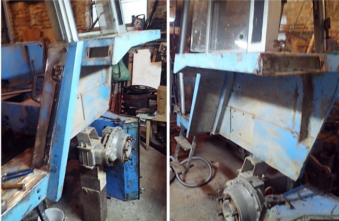
Slika 2: Stanje levega blatnika s sprednje (levo) in zadnje strani (desno) pred demontažo Vir: Berghaus, 2020
