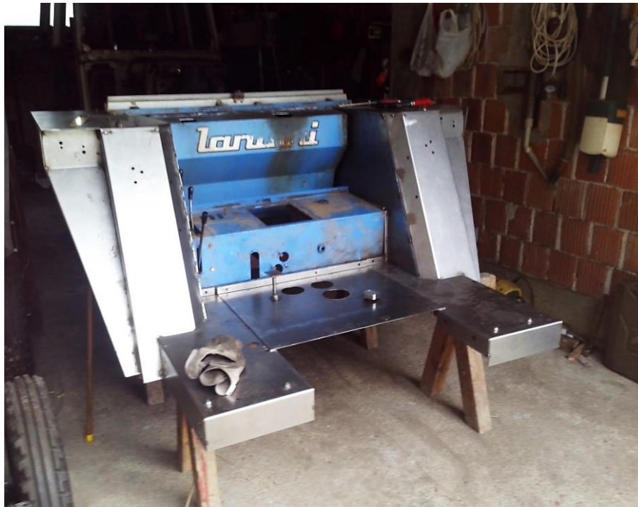
Slika 20: Poskusna montaža oziroma prileganje obeh blatnikov brez podvozja Vir: Berghaus 2020
