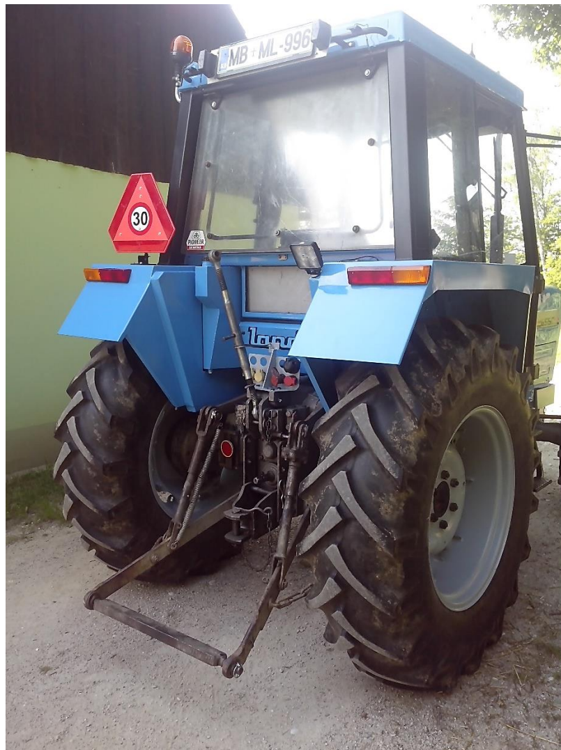
Slika 21: Prikaz končnega izdelka z zadnje strani, kjer se vidijo rezervoar in oba blatnika. Na rezervoarju manjka steklo za lažji pregled nad priključki.
