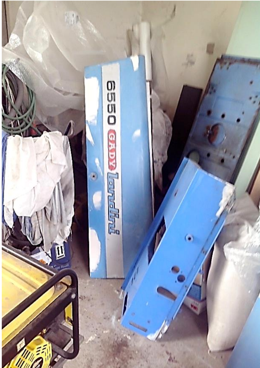
Slika 15: Očiščeni in pobrušeni deli, ki niso na novo konstruirani Vir: Berghaus 2020
