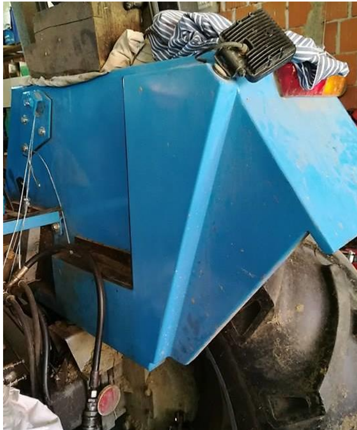
Slika 19: Montiran desni blatnik z vso elektroniko in lučmi Vir: Berghaus 2020
