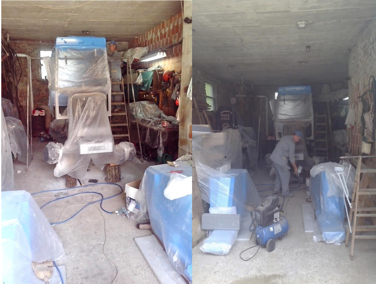
Slika 16: Barvanje izdelkov s pištolo na kompresor Vir: Berghaus 2020
