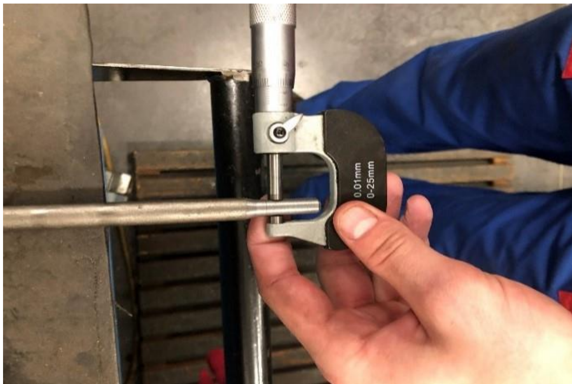
Slika 11: Merjenje izdelka po struženju Vir: AR Produkt, 2020b
