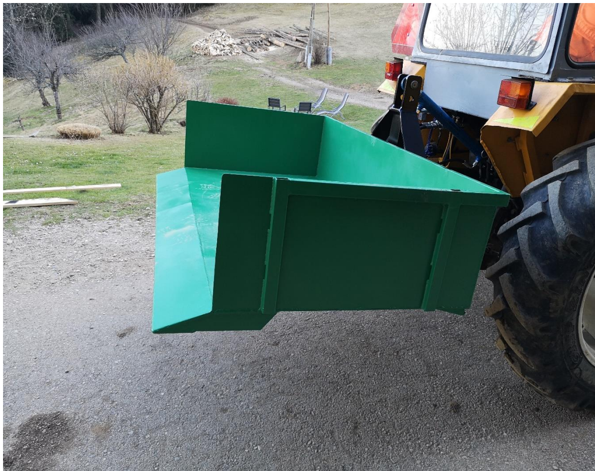
Slika 31: Montiran sklop traktorskega platoja
