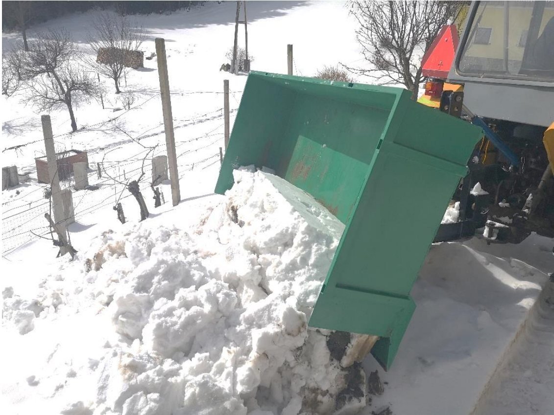
Slika 34: Plato v fazi nagiba pod kotom 70 ° Vir: Osvald, 2020
