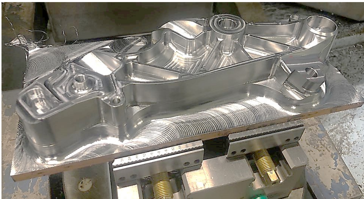
Slika 33: Rezkanje prve strani nosilca Vir: Stupan, 2019
