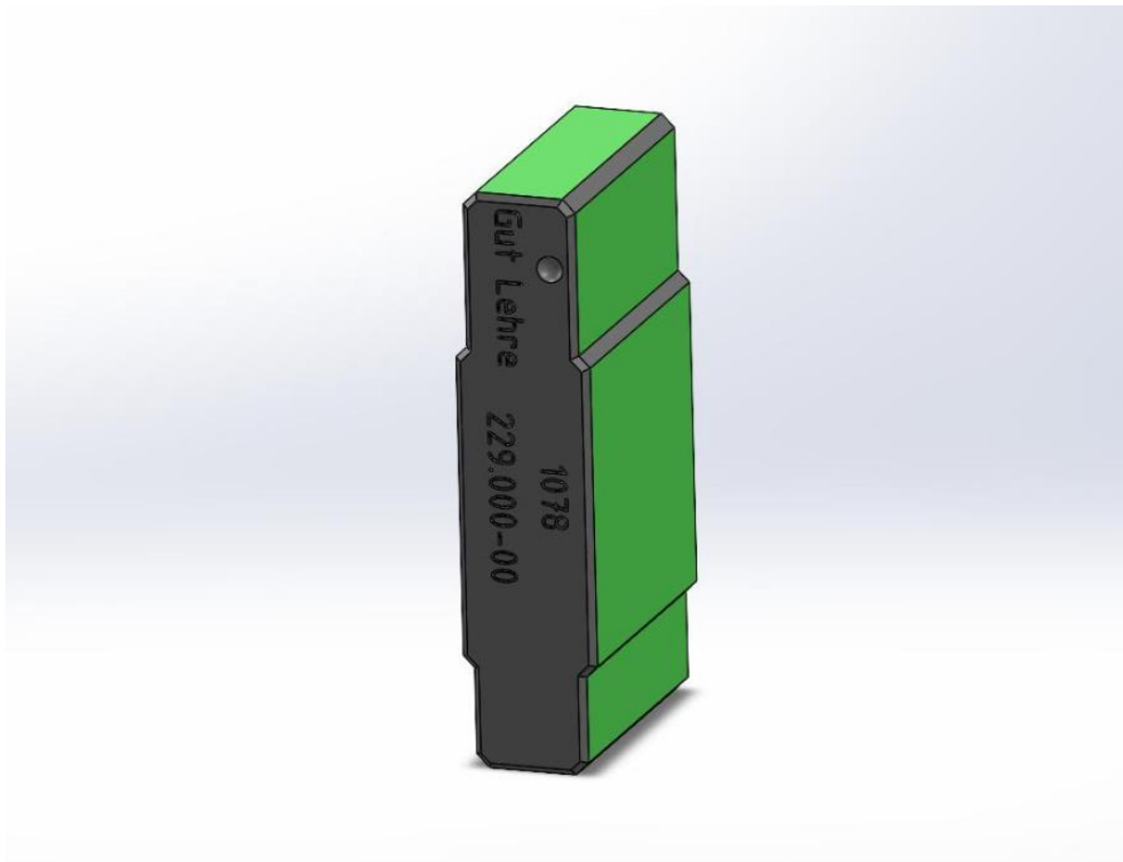
Slika 11: Prikaz vtikač – kontrola v 3D-obliki v programu SolidWorks (sprednja stran)
