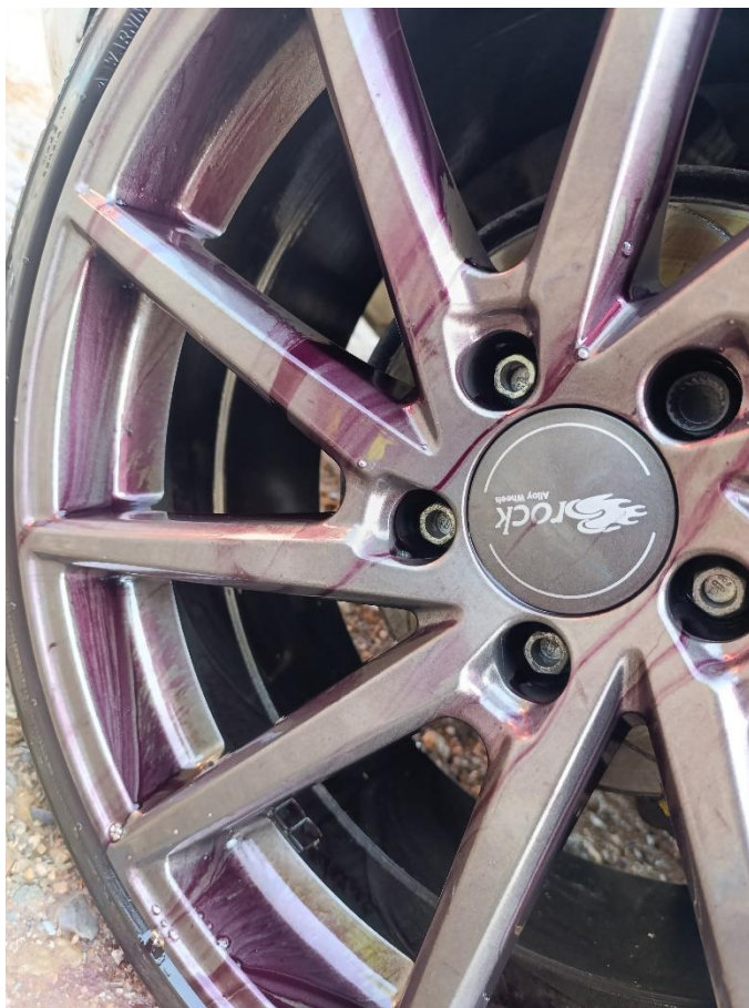
Slika 31: Kemična reakcija čistilnega sredstva za platišča
