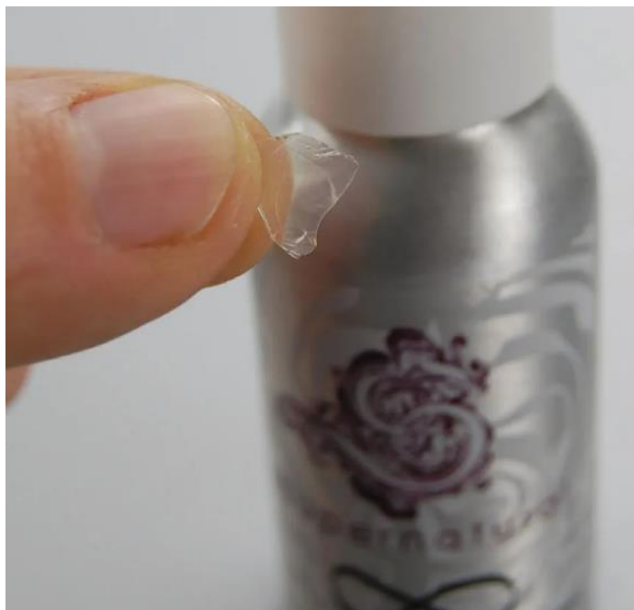
Slika 21: Delček keramičnega premaza
