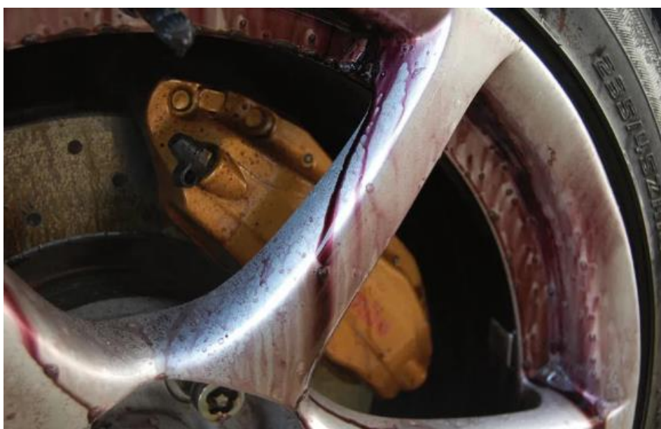
Slika 12: Reagiranje čistila za platišča s kovino
