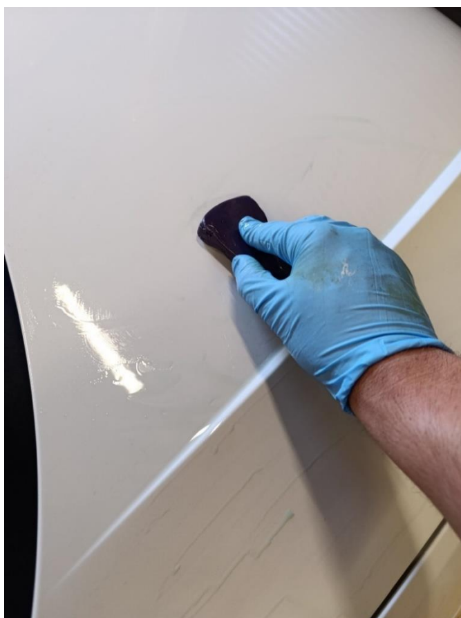
Slika 44: Postopek odstranjevanja delcev s čistilnim gnetilom
