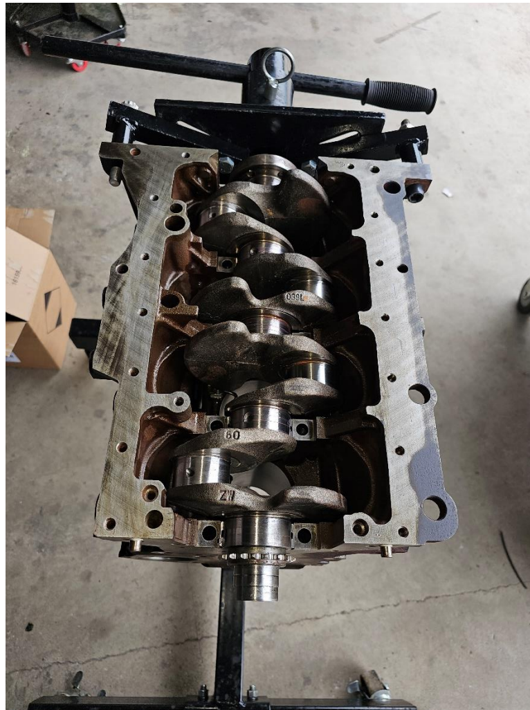
Slika 14: Nameščena ročična gred
