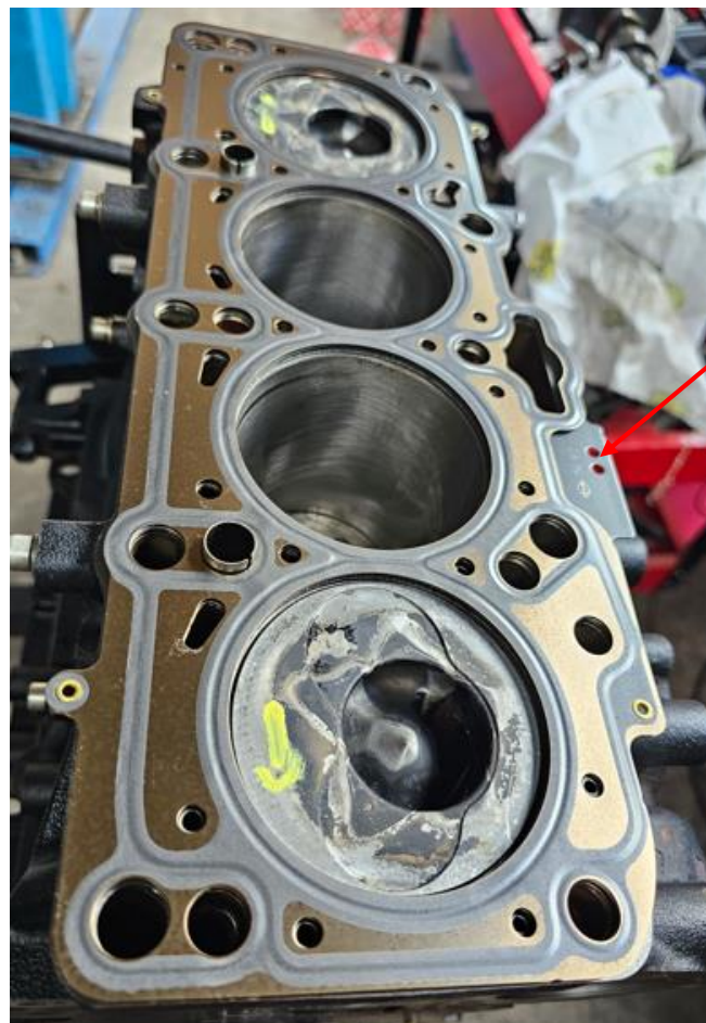
Slika 23: Nameščena tesnilka glave motorja
