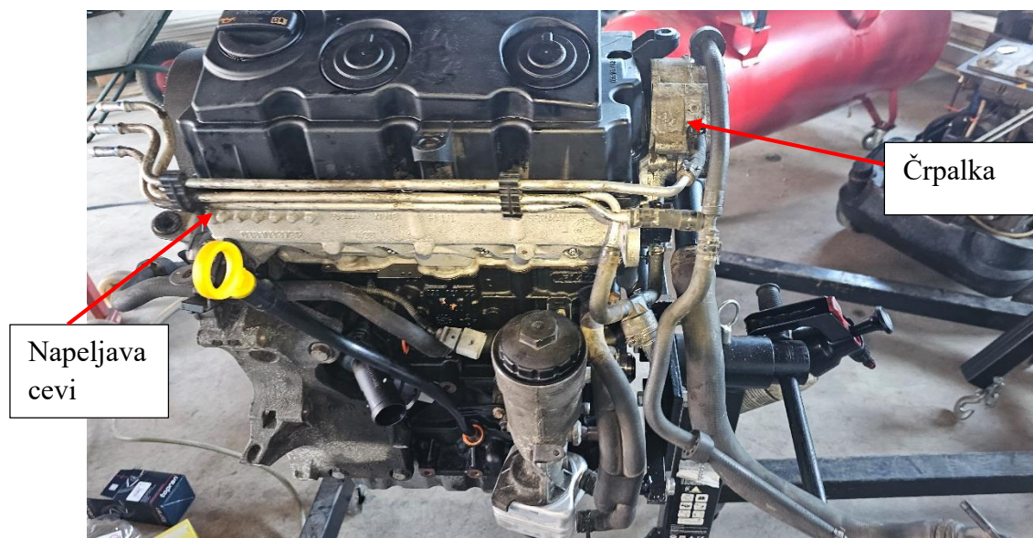
Slika 35: Napeljava cevi in črpalke
