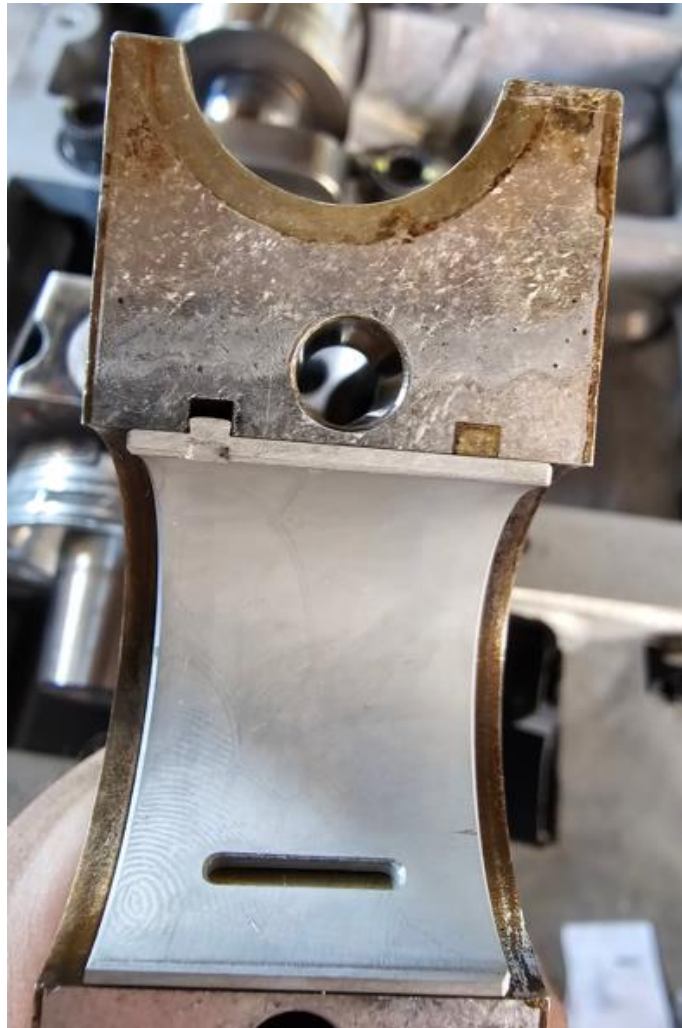
Slika 26: Ležajne blazinice na pokrovih
