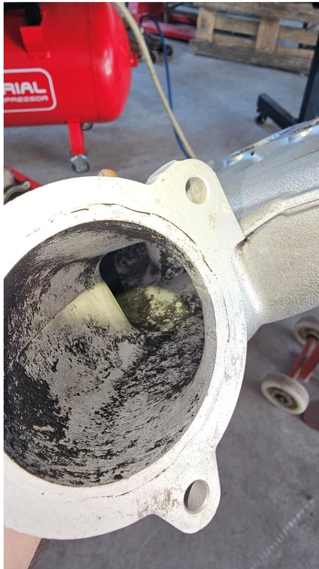
Slika 37: Očiščen sesalni kolektor
