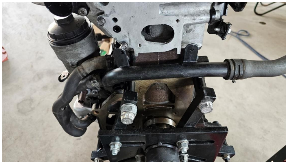
Slika 33: Cevi hladilne tekočine
