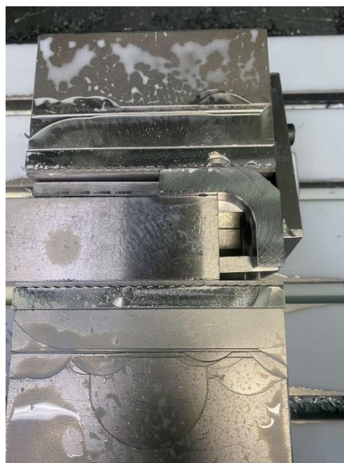
Slika 25: 2. operacija 5-osne obdelave
