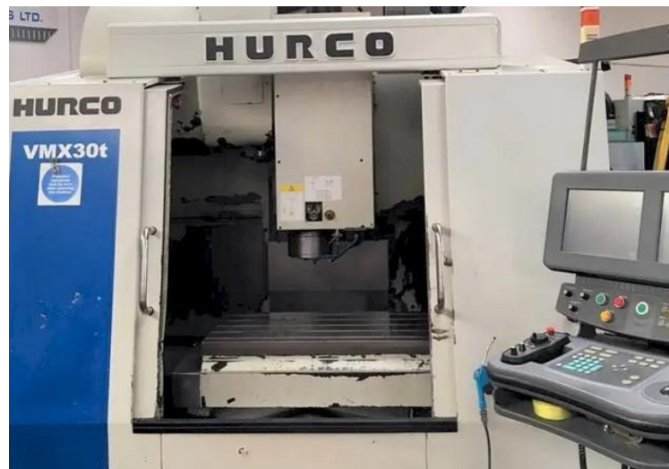
Slika 31: 3-osni CNC stroj Hurco VMX30t
