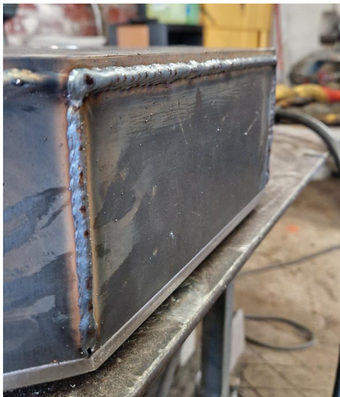
Slika 66: Pobrušeni zvari/končan zvarjenec
