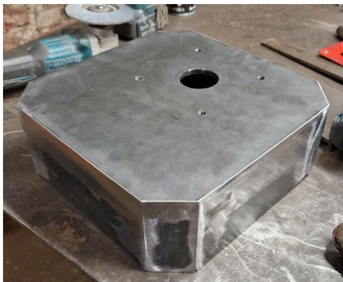
Slika 66: Pobrušeni zvari/končan zvarjenec
