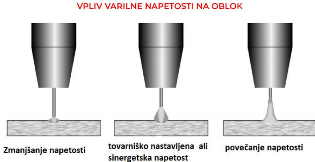
Slika 25: Vpliv varilne napetosti na oblok
