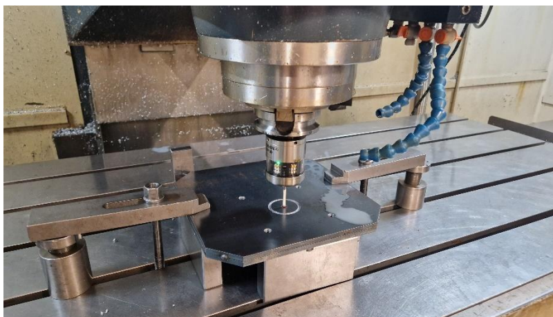
Slika 58: Umerjanje orodja s pomočjo 3D-tipala
