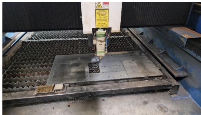
Slika 51: Laserska komora med razrezom
