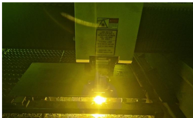
Slika 51: Laserska komora med razrezom
