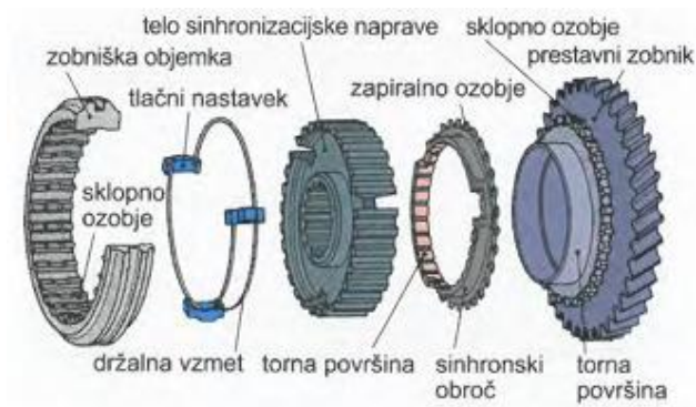
Slika 2: Enostavna sinhronizacijska naprava z notranjo sinhronizacijo
