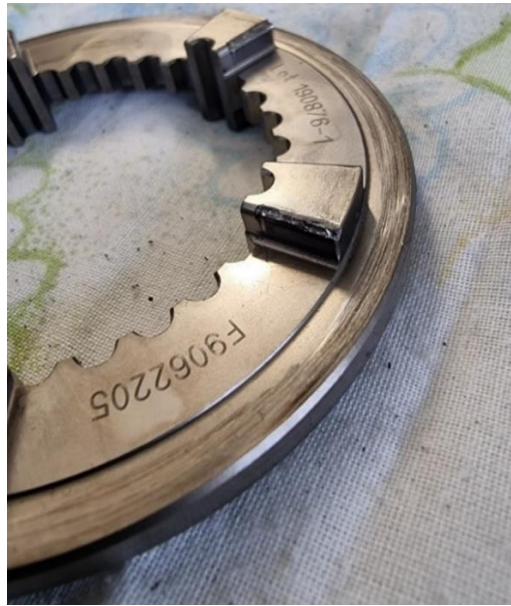
Slika 18: Slika poškodovanega "dog ringa"
