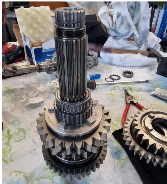
Slika 19: Razdrta sekundarna gred
