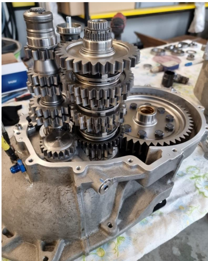
Slika 22: Slika menjalnika z vstavljenimi gredmi
