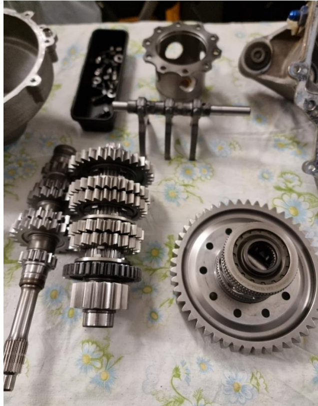
Slika 7: Primarna (levo) in sekundarna (desno) gred ter diferencial in prestavne vilice
