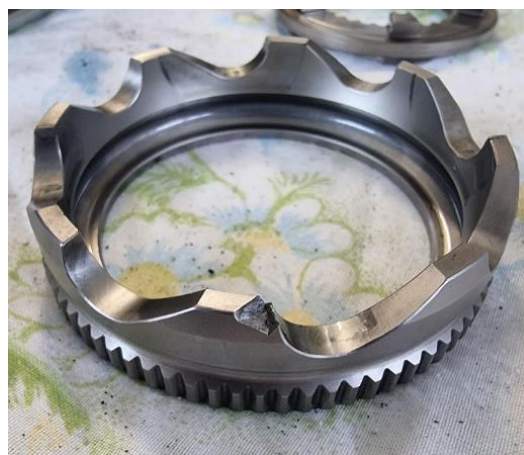
Slika 16: Slika poškodovane rampe
