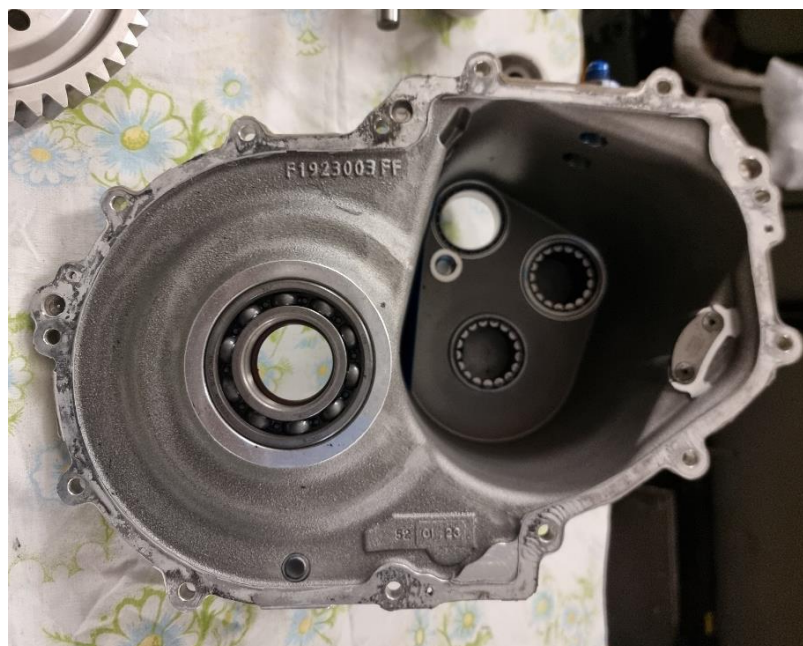
Slika 13: Ohišje menjalnika pred čiščenjem naležne površine in menjavo ležajev
