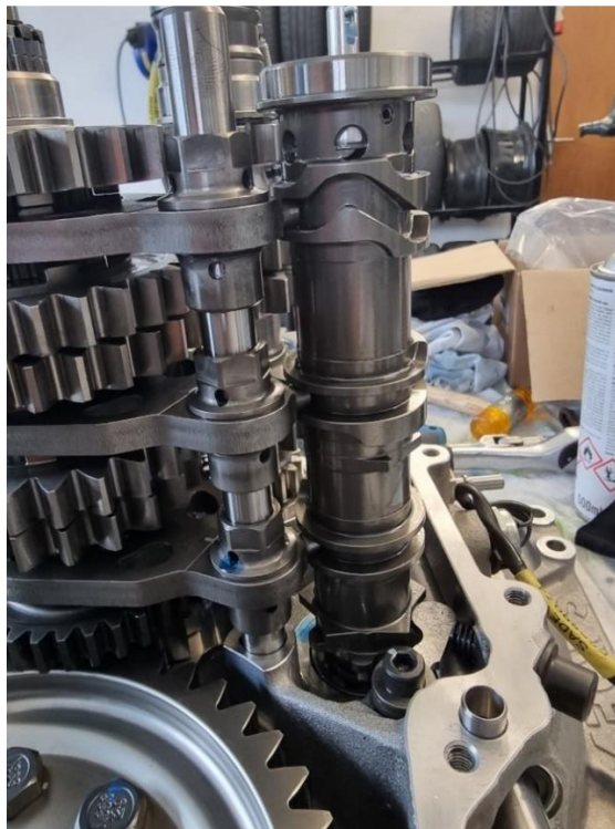
Slika 9: Slika vstavljenih vilic v »dog ring«
