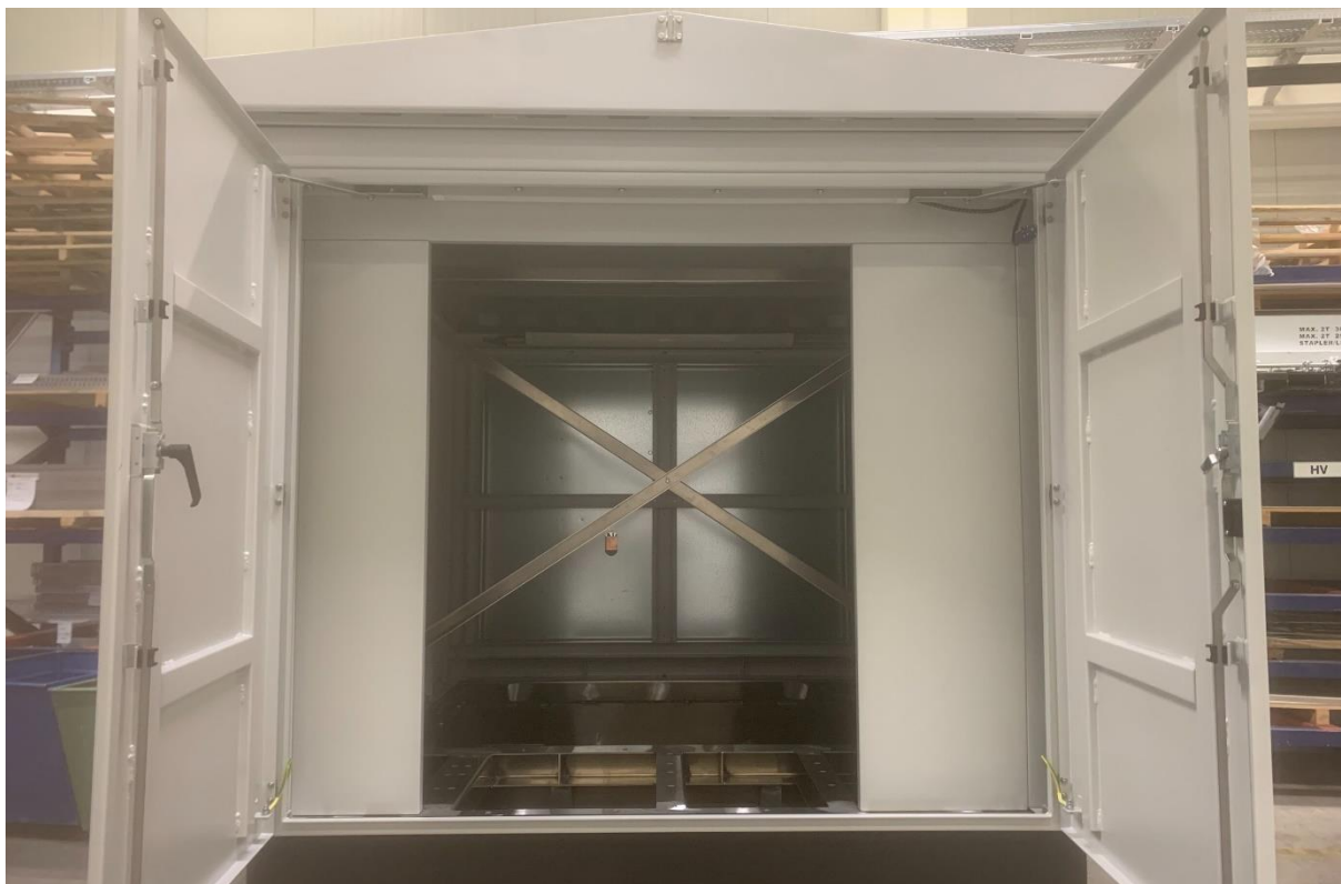
Slika 33: Dokončana sestava mobilne transformatorske postaje
