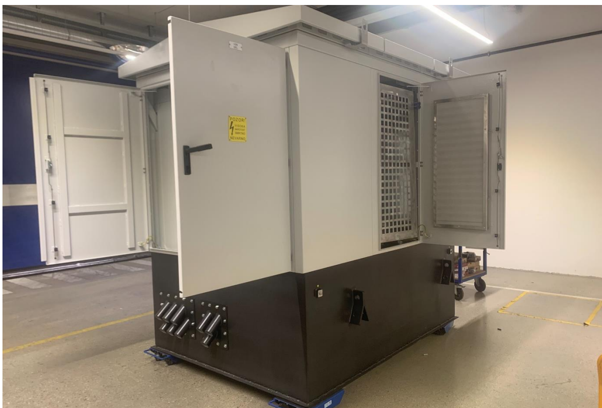
Slika 33: Dokončana sestava mobilne transformatorske postaje
