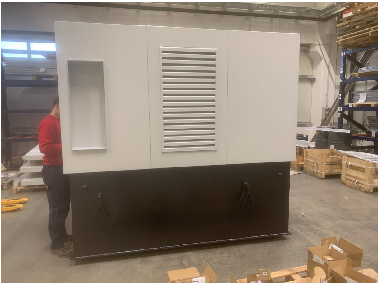
Slika 26: Vijačenje stranskega dela ohišja na podnožje
