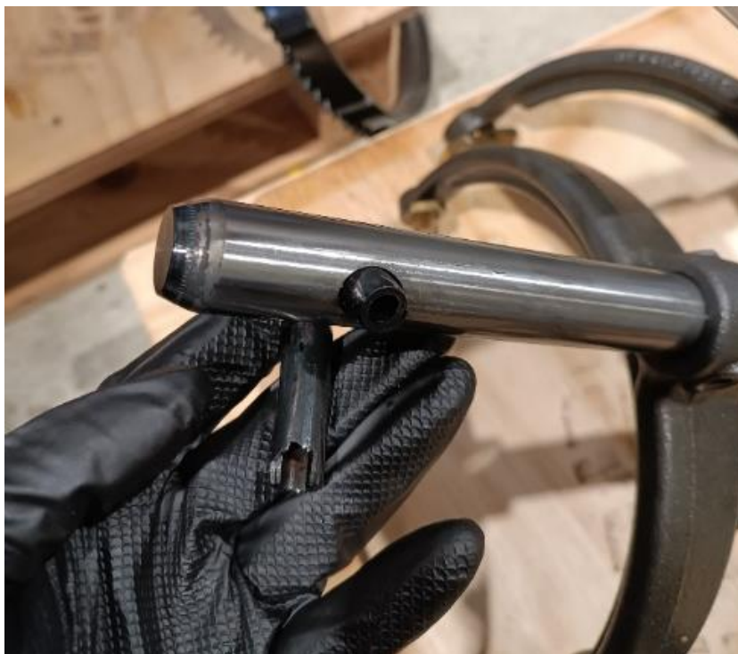
Slika 19: Izgled poškodovanega in novega zatiča
