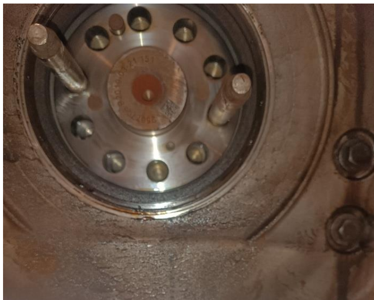
Slika 12: Izgled puščanje olja na oljnem tesnilu
