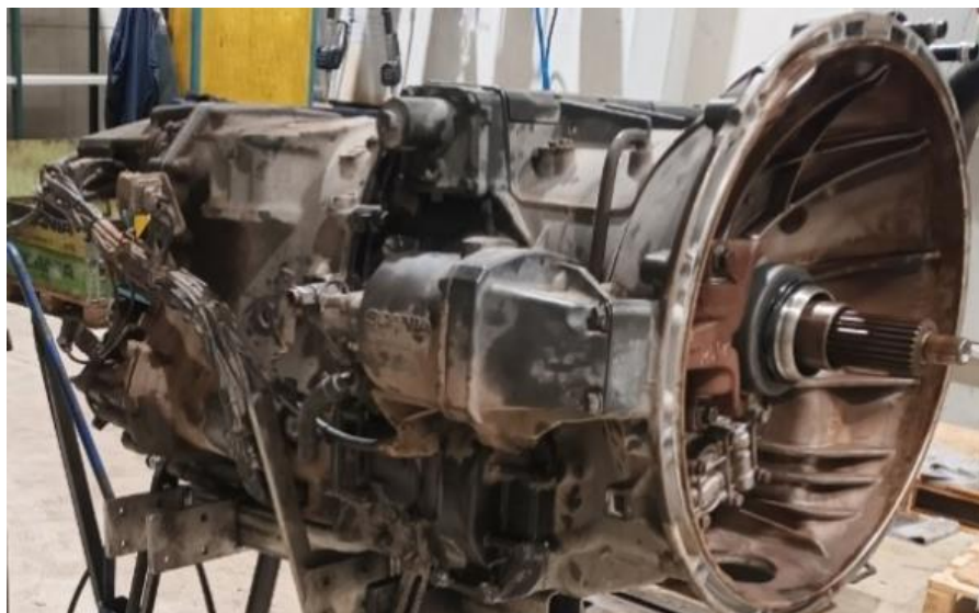
Slika 6: Izgled sistema za prenos moči GRS905R
