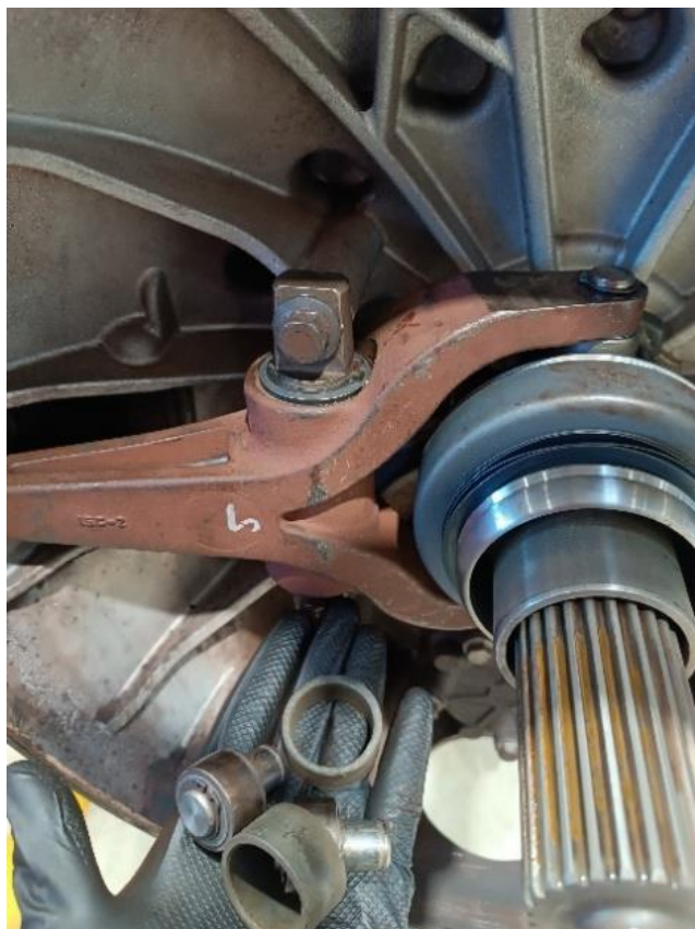
Slika 23: Izgled obnovljene vklopne vilice z potisnim ležajem
