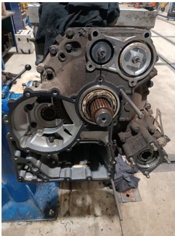
Slika 16: Izgled menjalnika z demontirano tokovno zavoro
