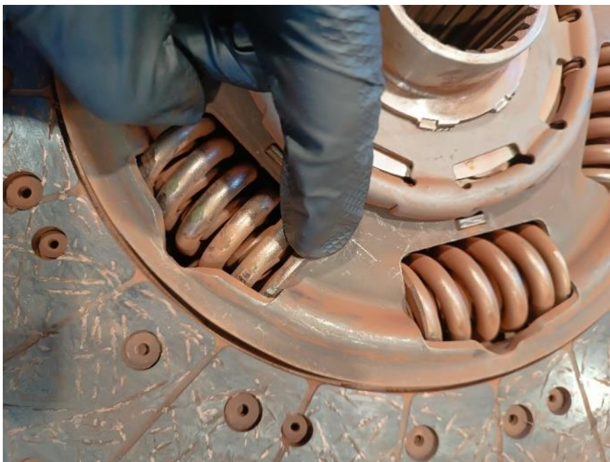
Slika 11: Izgled obrabljene dušilne vzmeti in sklopkine lamele
