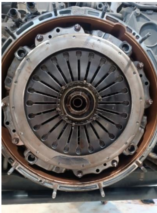
Slika 13: Izgled nove sklopke
