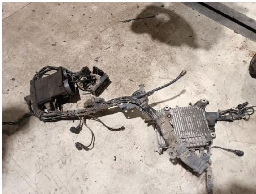
Slika 15: Izgled snete električne inštalacije in cevi zraka
