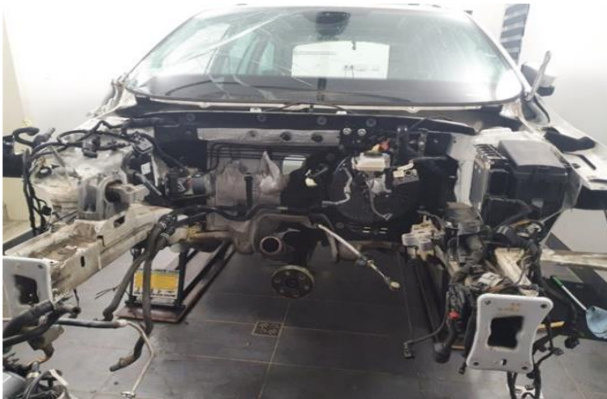
Slika 14: Vozilo z izvzetim motorjem
