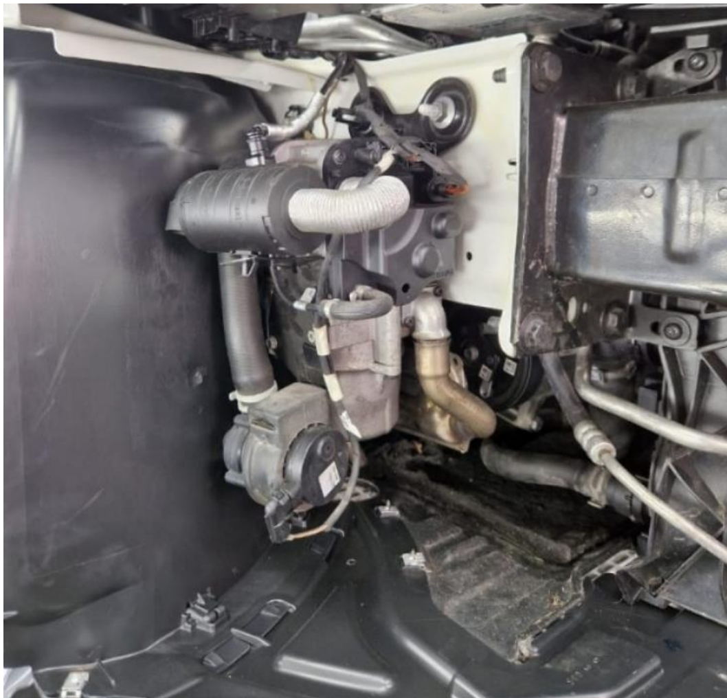
Slika 38: Montiran novi grelec mirujočega vozila
