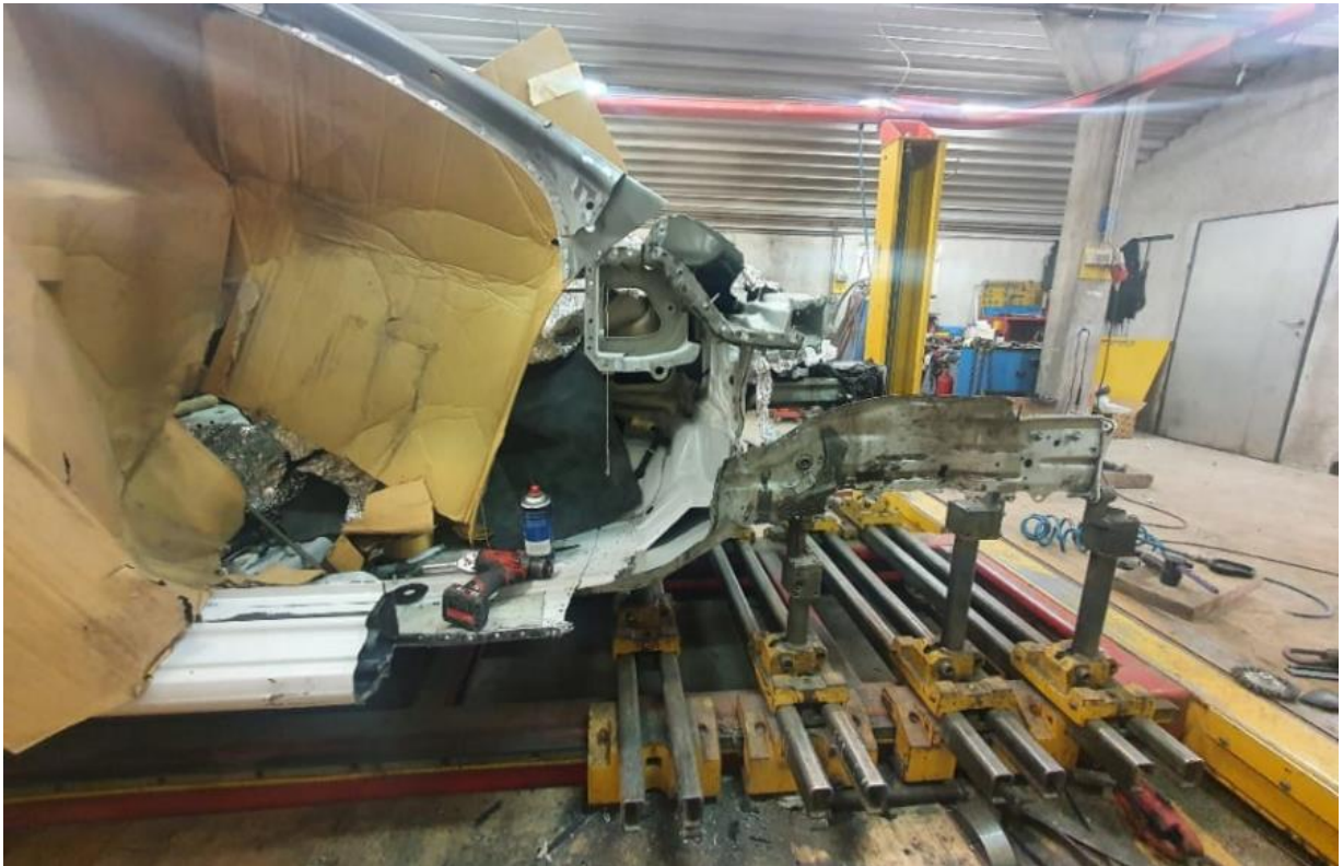
Slika 21: Pripravljena karoserija za vležišče novega karoserijskega dela
