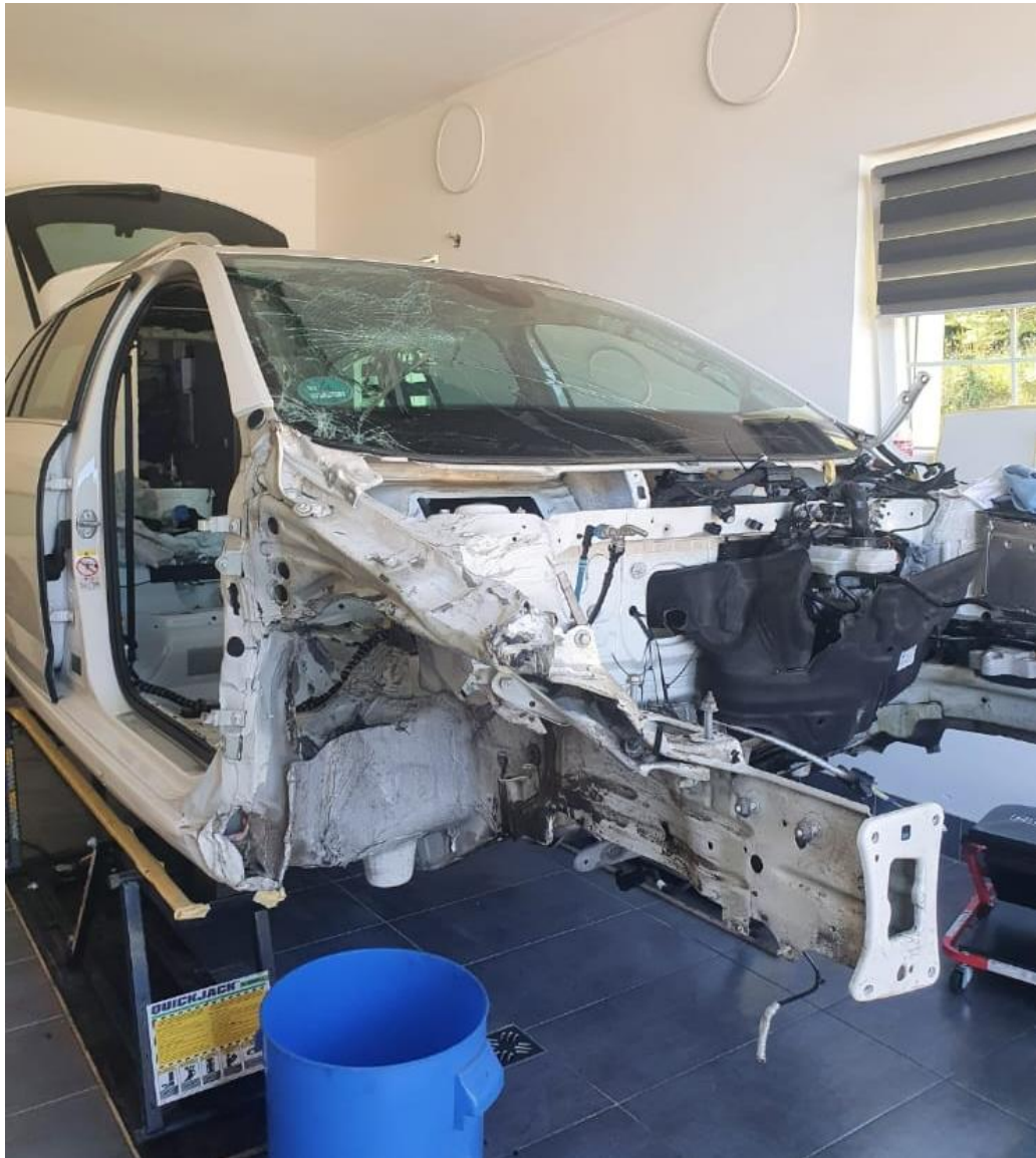
Slika 15: Demontirani zunanji desni del poškodovanega kraka vozila
