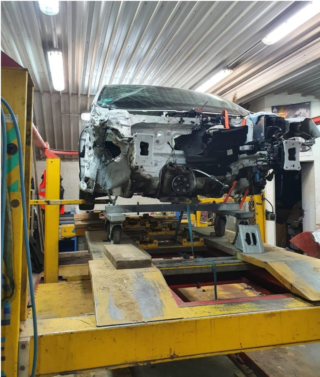
Slika 17: Priprava vozila za vpenjanje na kleparsko mizo
