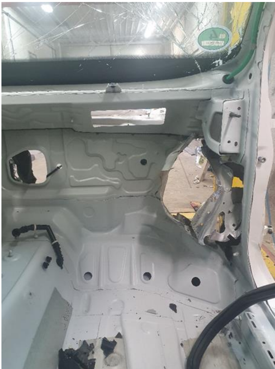
Slika 11: Demontirana notranja požarna stena vozila
