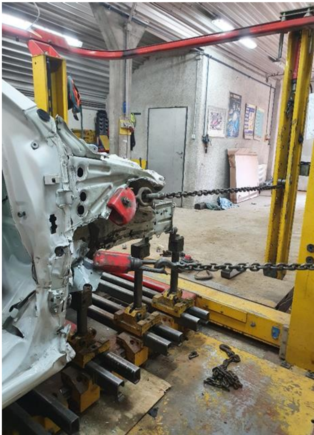
Slika 20: Razvlek poškodovanega vozila s kleparskimi čeljustmi
