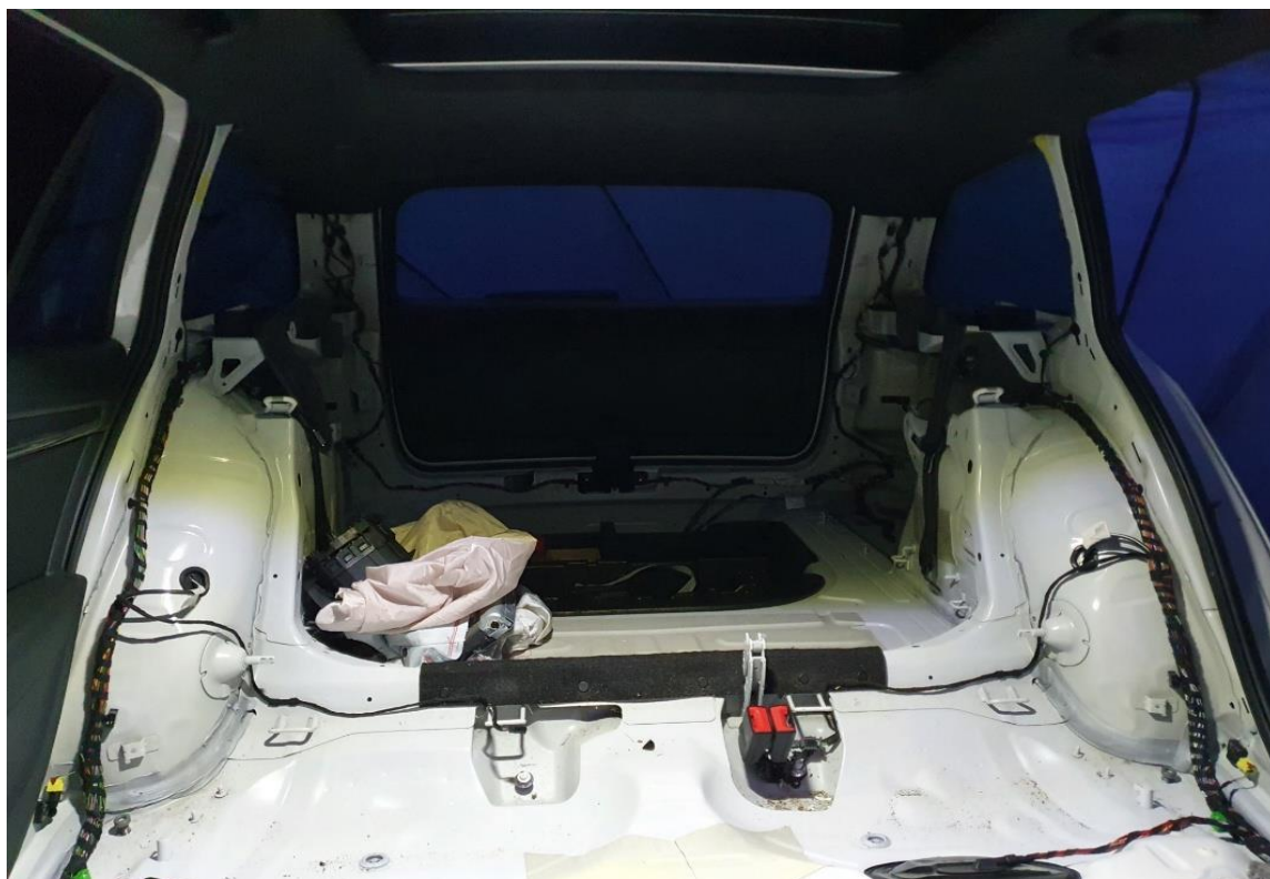
Slika 12: Demontiran prtljažni prostor vozila
