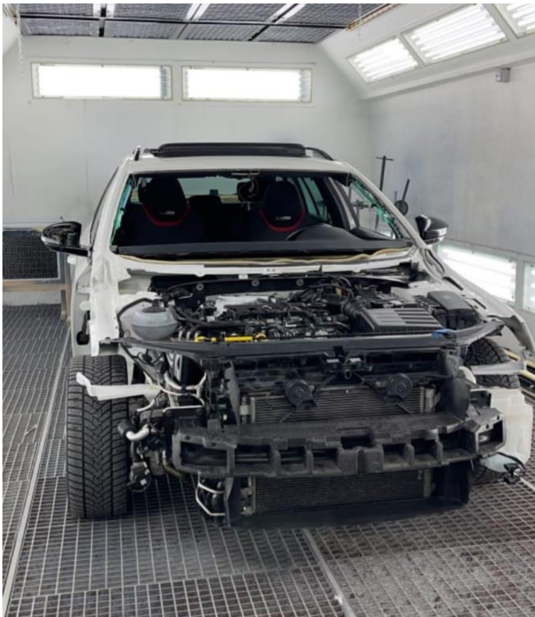
Slika 44: Vozilo z vstavljenim hladilnim sistemom in vezno steno
