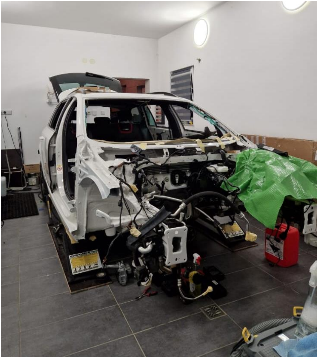
Slika 41: Vozilo, pripravljeno za vstavitve motorja
