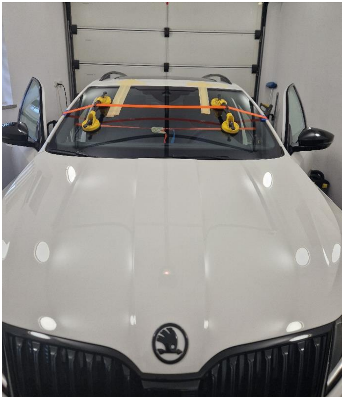
Slika 51: Vstavitev vetrobranskega stekla
