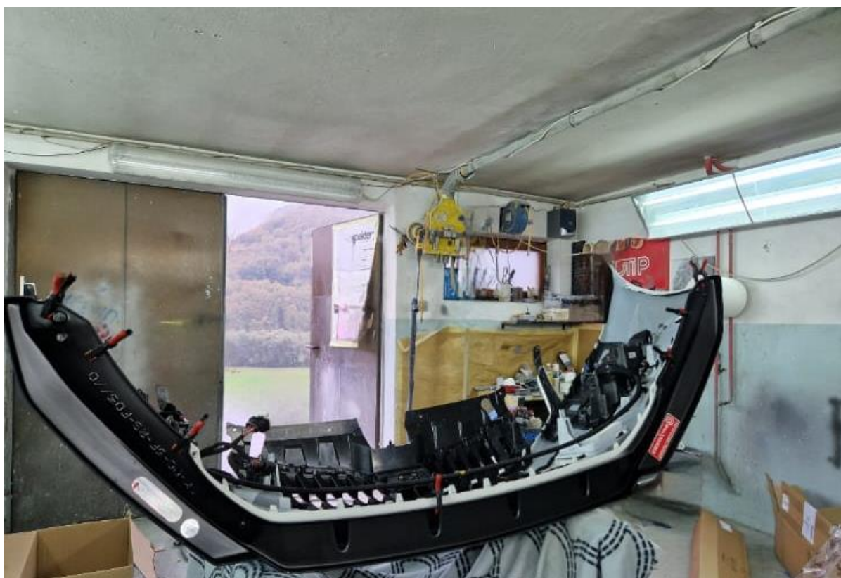
Slika 52: Montaža sprednjega podaljška odbijača
