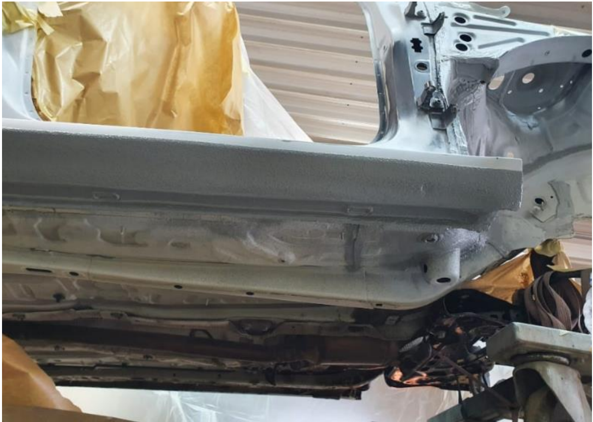
Slika 30: Nanos novih tesnilnih mas na prag vozila
