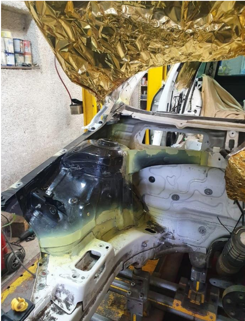
Slika 26: Nov privarjen in zaščiten del na karoserijo vozila
