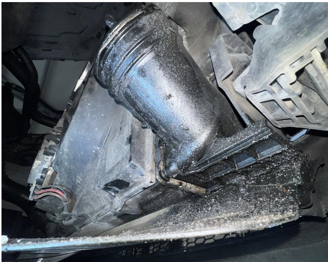
Slika 29: Puščanje olja iz intercoolerja zaradi netesnosti.
