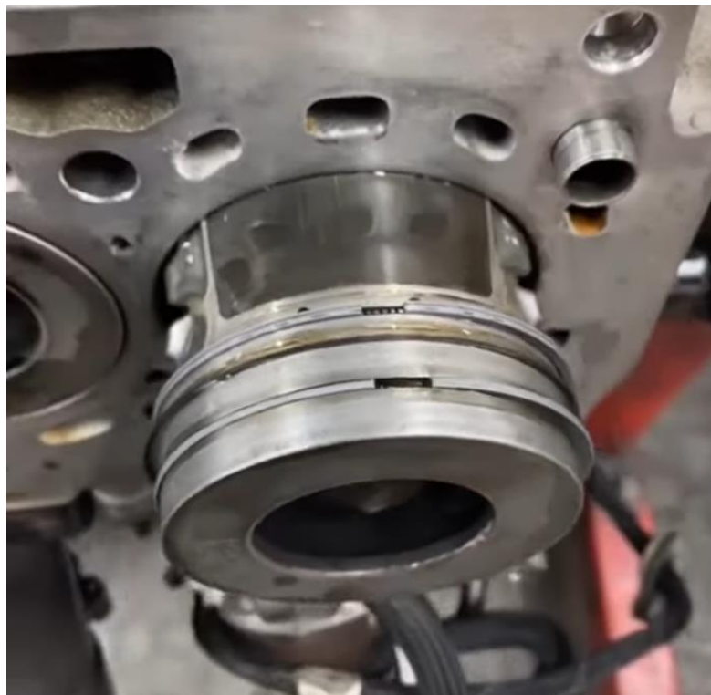
Slika 15: Vgradnja bata v cilinder
