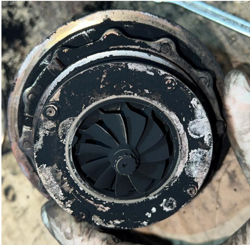
Slika 25: Zamašen turbinski mehanizem z ogljikovimi usedlinami
