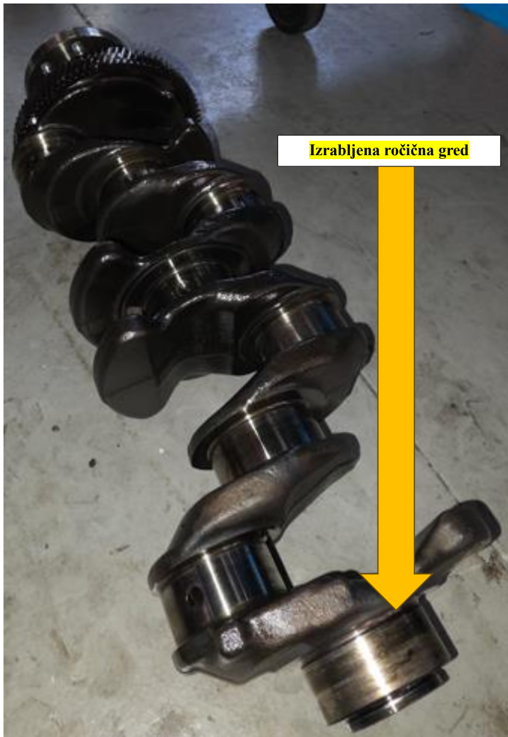
Slika 10: Poškodovana ročična gred
