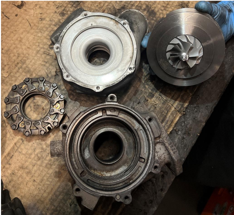
Slika 26: Razstavljen turbinski sklop po čiščenju
