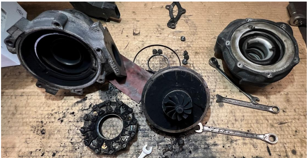
Slika 25: Zamašen turbinski mehanizem z ogljikovimi usedlinami
