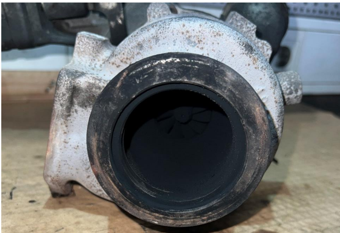
Slika 23: Notranjost turbine pred obnovo
