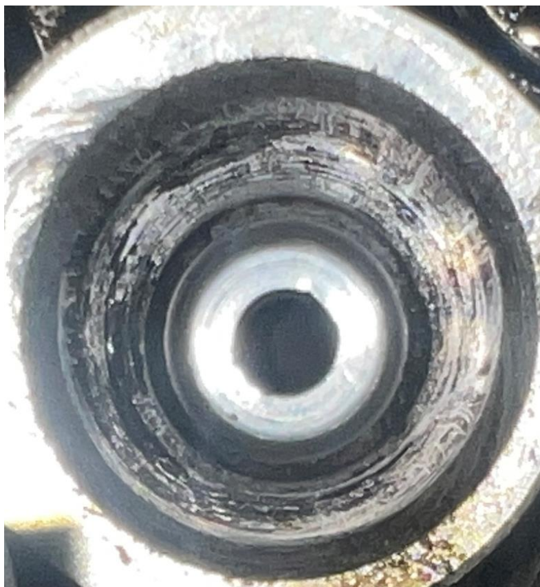
Slika 20: Očiščeno sedišče injektorjev
