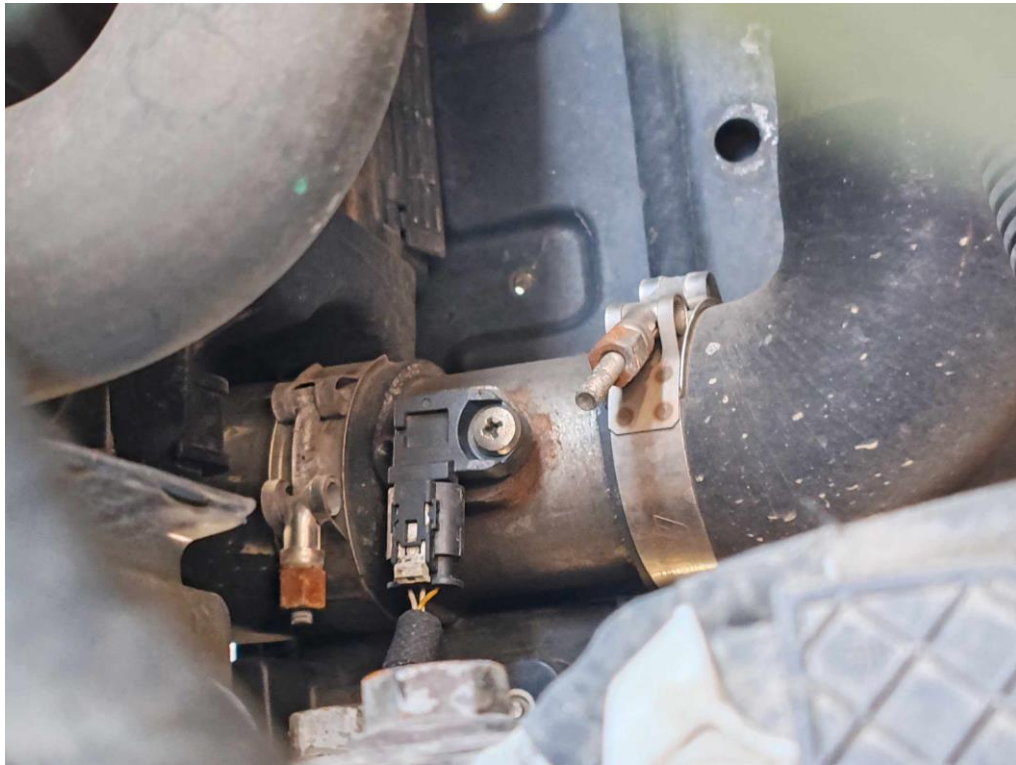
Slika 20: Preizkušanje temperaturnih razlik I.A.T. (intake air temp.)
