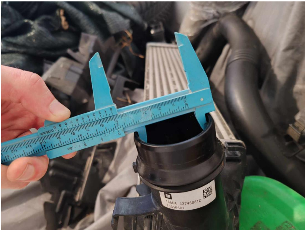
Slika 18: Zunanji premer nove cevi
