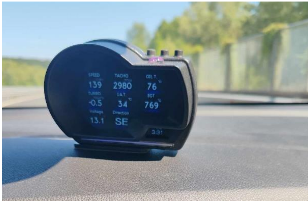
Slika 20: Preizkušanje temperaturnih razlik I.A.T. (intake air temp.)
