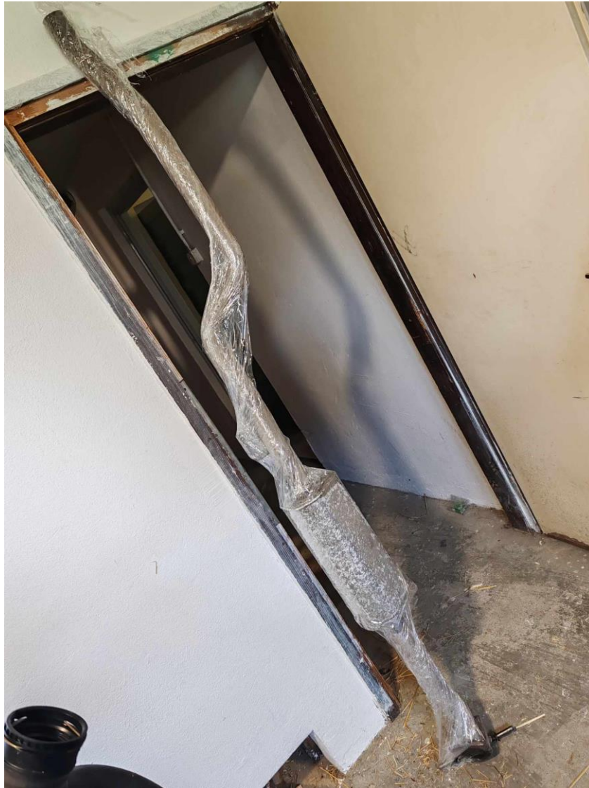
Slika 26: Originalni sredinski glušnik
