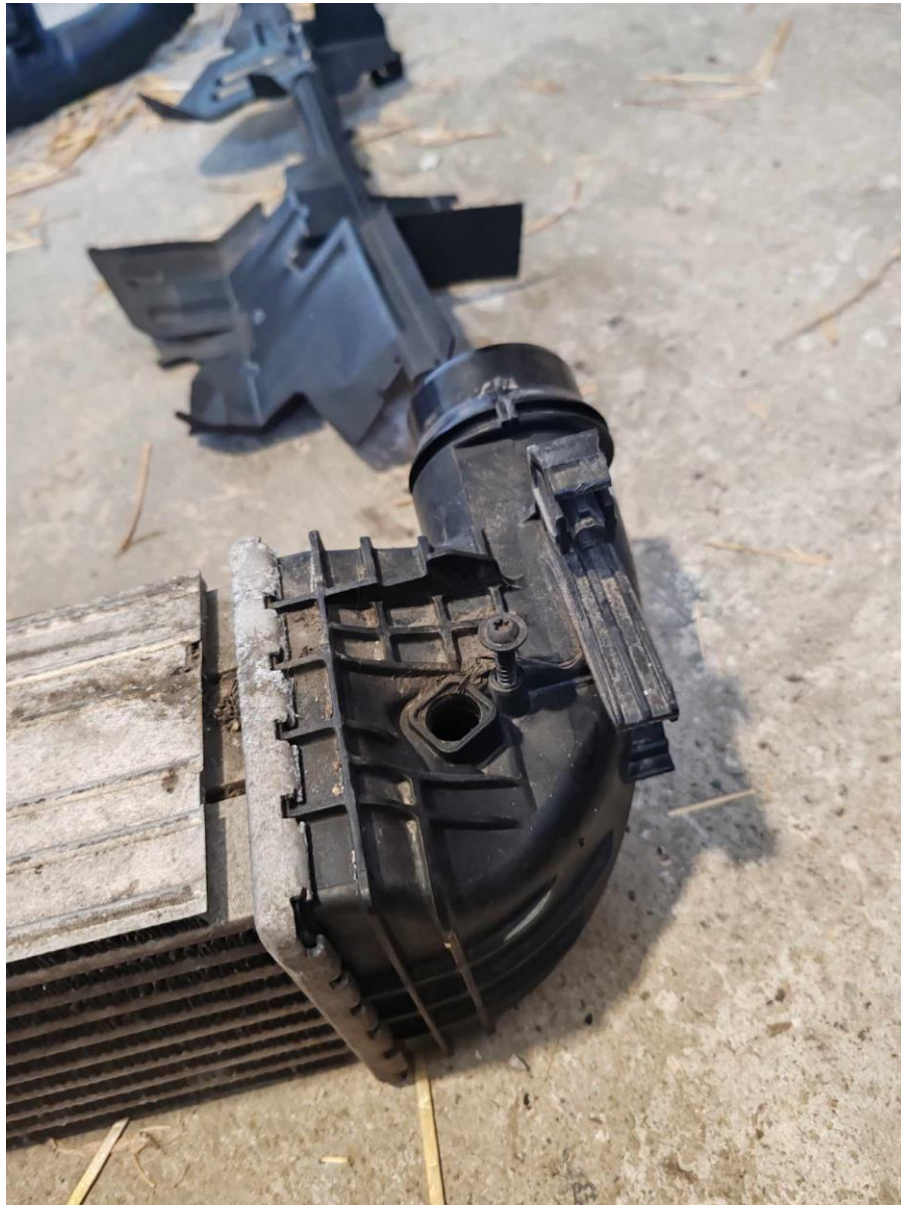
Slika 16: Originalna prirobnica senzorja
