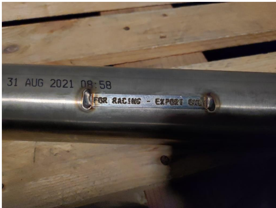
Slika 28: Nova sredinska cev (brez glušnika)
