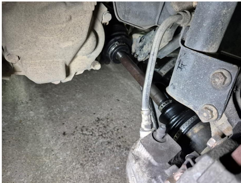
Slika 14: Montirana polosovina z novimi manšetami
