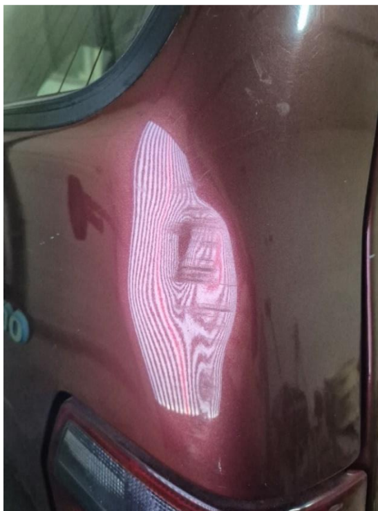
Slika 33: Odsev kleparske luči na vdolbini
