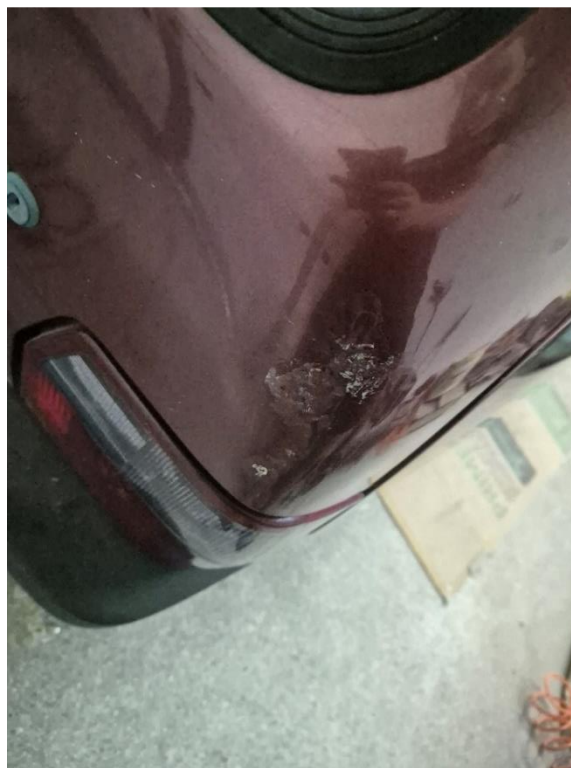
Slika 35: Vdolbina med postopkom izvleka
