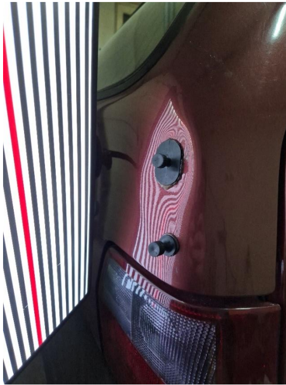
Slika 35: Vdolbina med postopkom izvleka
