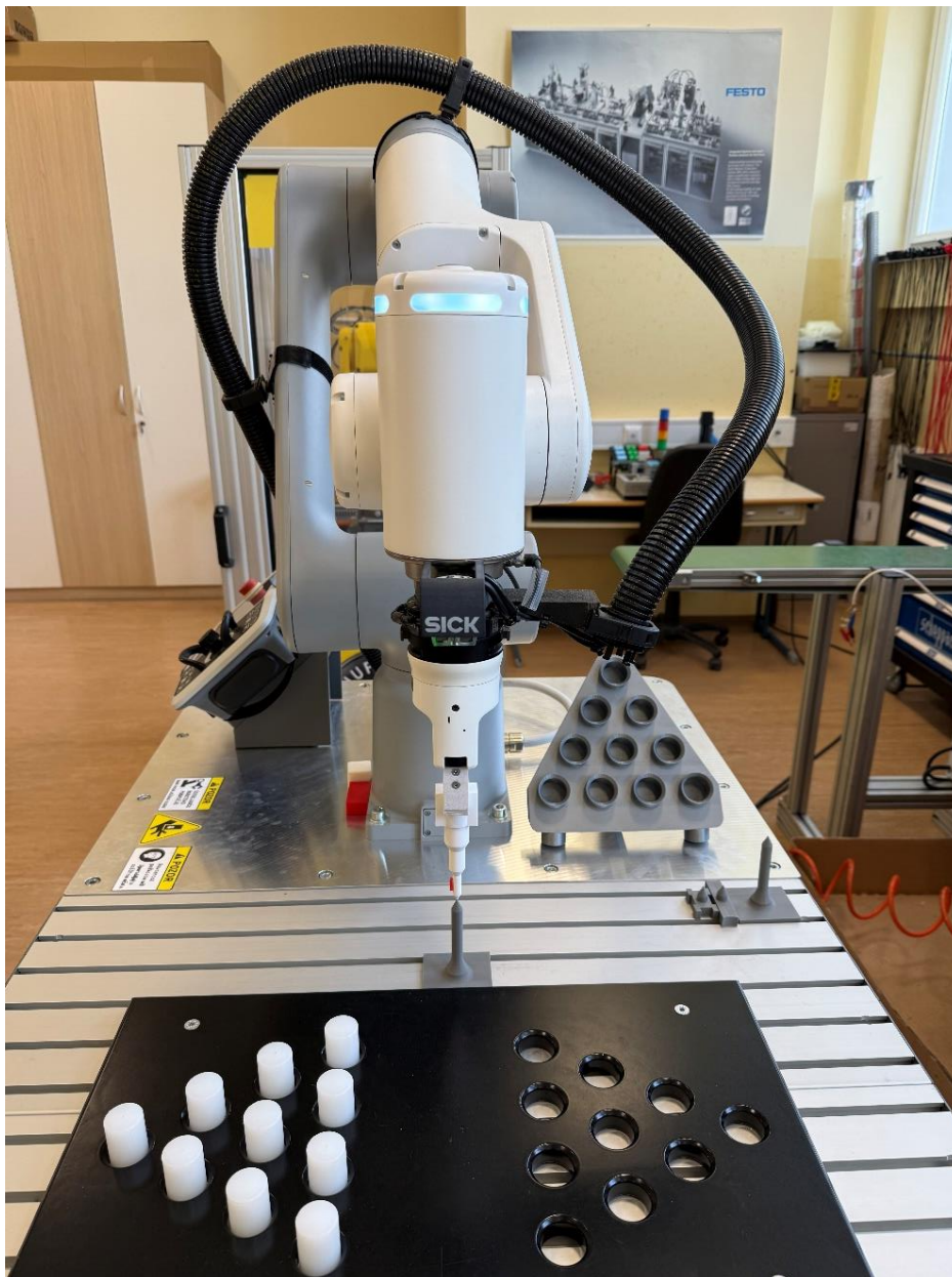
Slika 90: Robot v poziciji za nastavljanje TCP
