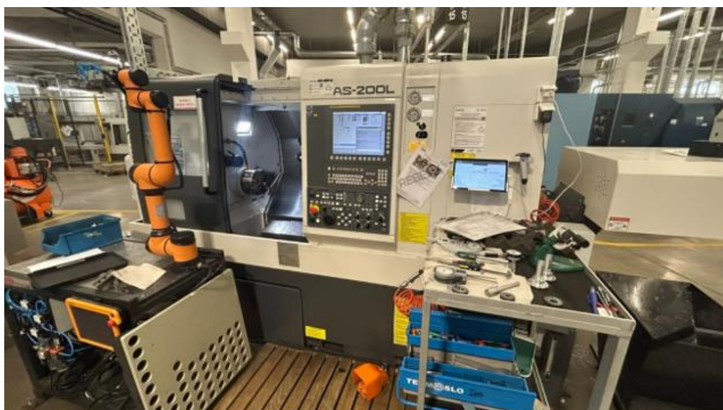
Slika 10: CNC-stroj z nameščeno tablico za digitalno planiranje in evidenco dela
