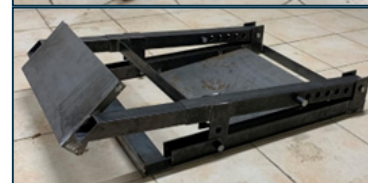
Slika 3: Prilagodljivo stojalo za volan za simulacijo vožnje | Vir: lasten (2025).
