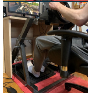
Slika 4: Prilagodljivo stojalo za volan za simulacijo vožnje in njegova uporaba. Vir: lasten (2025).
